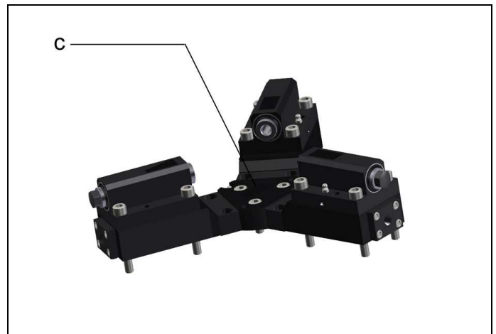
Abb. 2: Aufbau 3er Kreuzung Außenspannung
