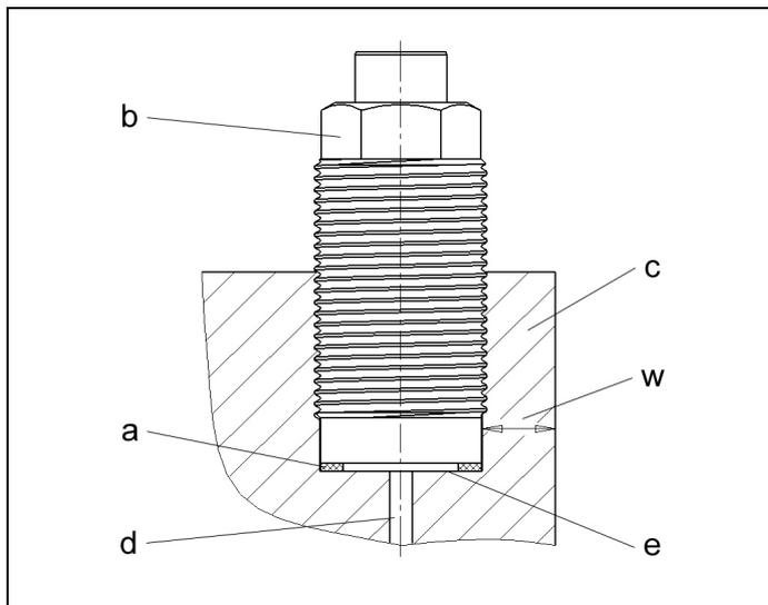
Abb. 6: Einbau der Axialdichtung auf Planfläche
